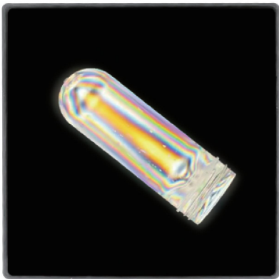
PSM-S02 检测PET瓶在0°和45°下的应力图谱
