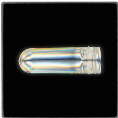
PSM-S02 检测PET瓶在0°和45°下的应力图谱
