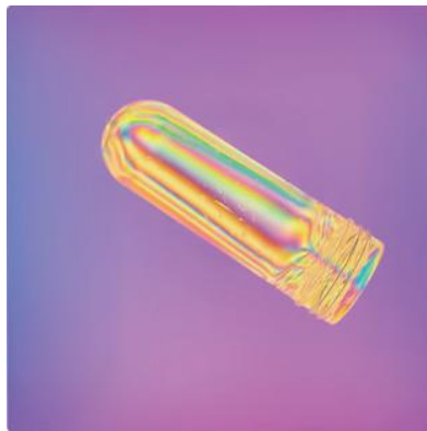
PSM-S02 检测PET瓶在0°和45°下的应力图谱
