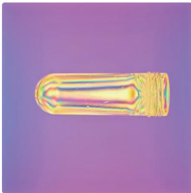
PSM-S02 检测PET瓶在0°和45°下的应力图谱
